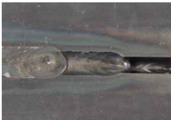
FOCUS.PULS – Soudage à plusieurs couches avec angle d'ouverture réduit (25°). Sécurité maximale des cordons de soudure (voir l'image de la coupe polie). Le résultat compte.
