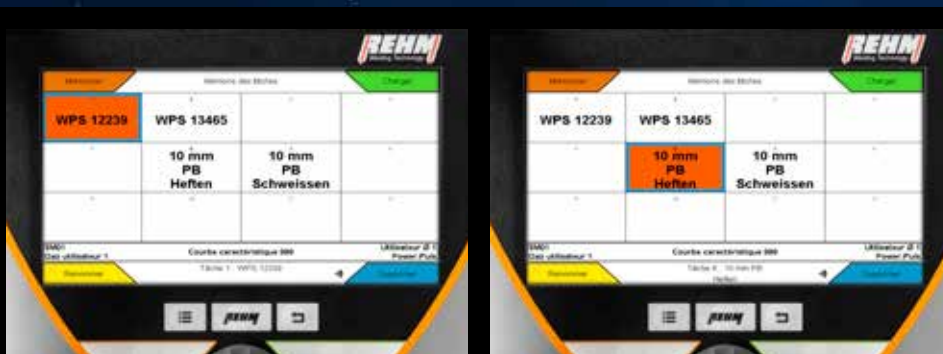
Les paramètres pertinents sont toujours au premier plan, ce qui permet à l'opérateur de les reconnaître à distance
