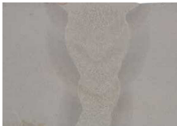
FOCUS.PULS – Soudage à plusieurs couches avec angle d'ouverture réduit (25°). Sécurité maximale des cordons de soudure (voir l'image de la coupe polie). Le résultat compte.
